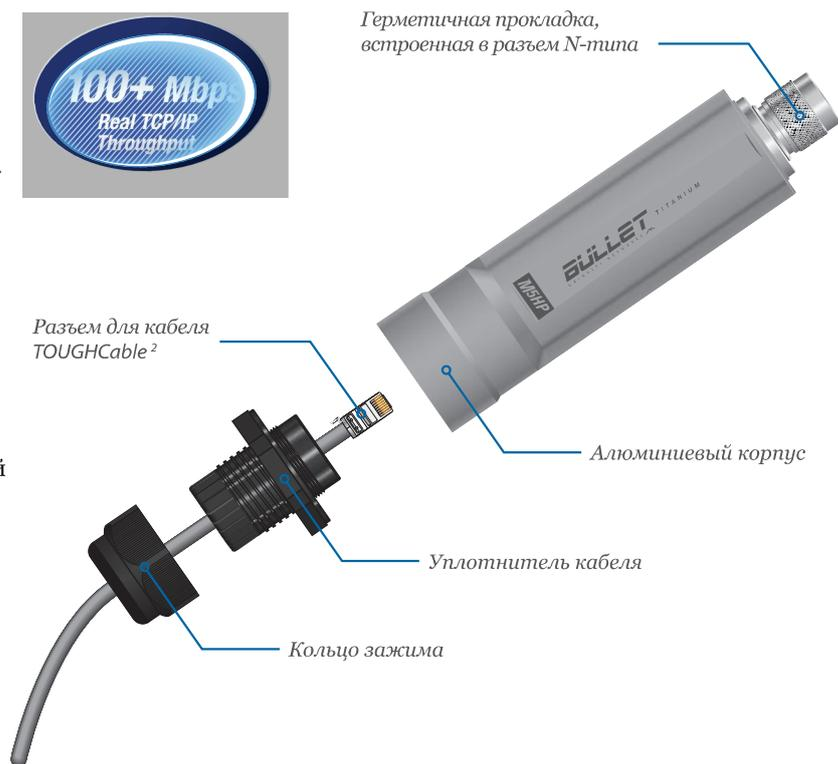
Bullet M Titanium разработан специально для работы в суровых климатических условиях. Благодаря усовершенствованию конструкции - алюминиевому корпусу, герметичной прокладке, встроенной в разъем N-типа и уплотнителю кабеля - Bullet M Titanium является практически "пуленепробиваемым".
