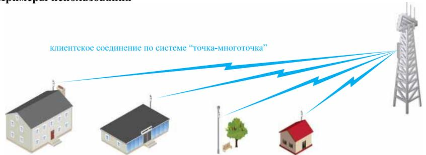
*Использование NanoStation M в качестве мощного клиентского оборудования при создании сети по системе "Точка-Многоточка"*
